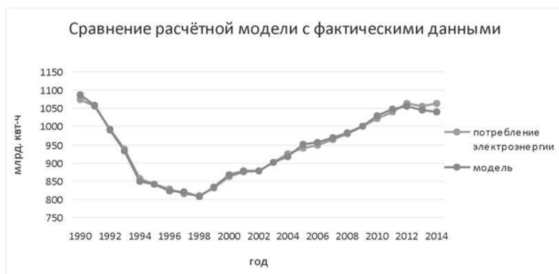
Рис. 2. Изменения производства электроэнергии (сравнение расчётной модели с фактическими данными)
